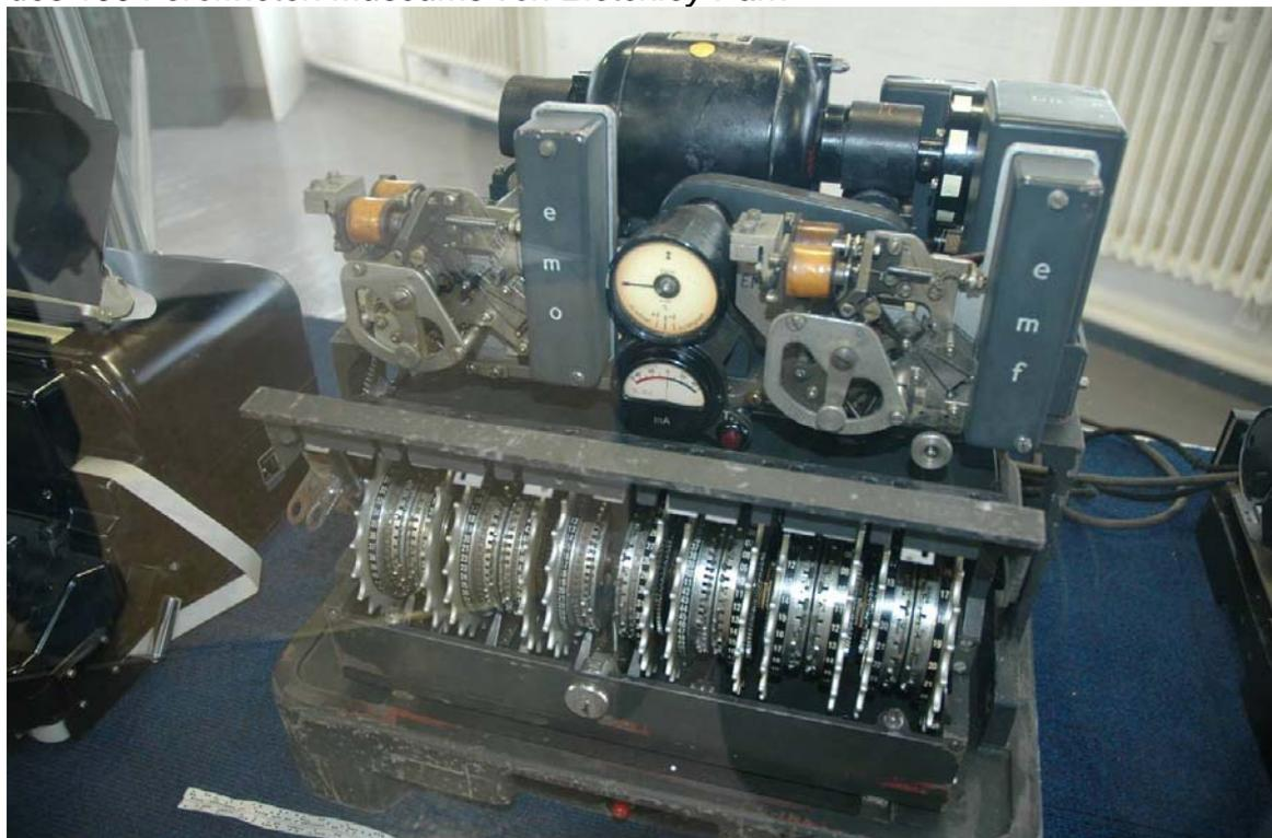
*Die Lorenz Zifferzusatzmaschine SZ42. Sie diente dazu, die Signale eines Fernschreibers zu verschlüsseln.*
